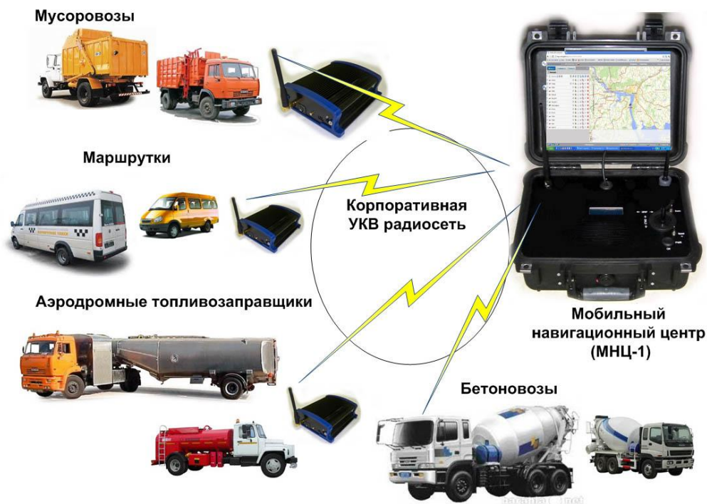
Рисунок 8 – Вариант использования изделия ГАЛС-Т2М в корпоративных информационно-навигационных системах
