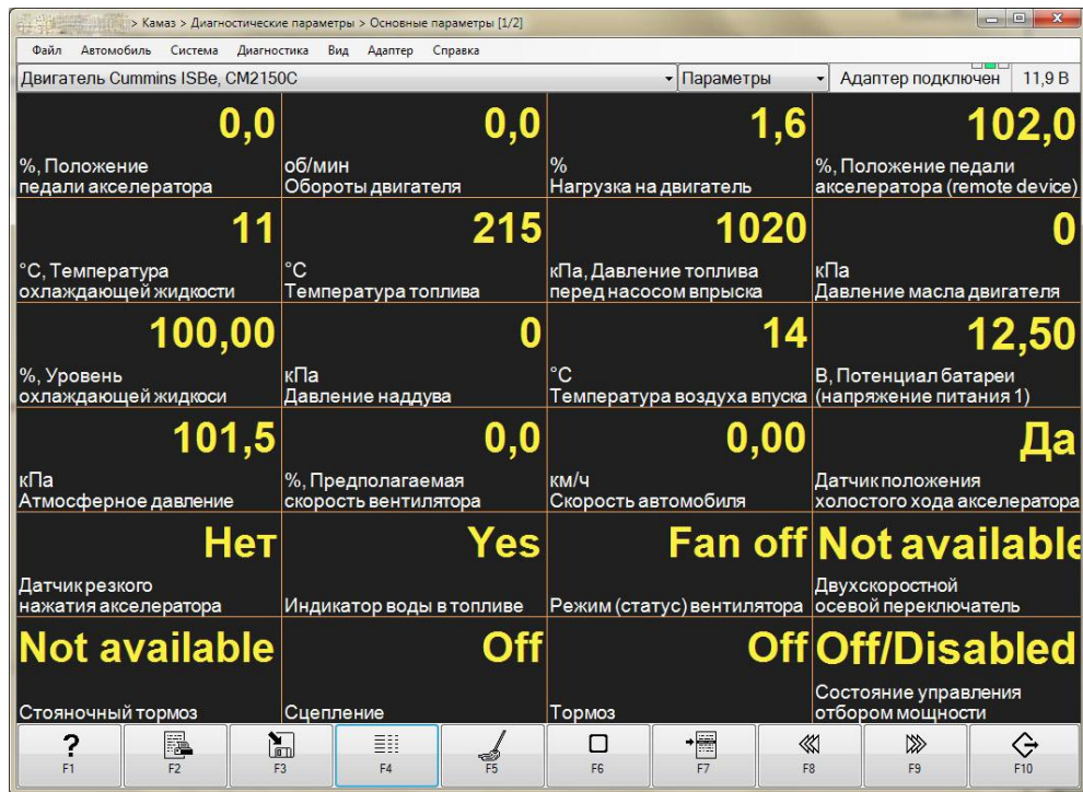
Рисунок 5 – Пример отображения диагностических параметров транспортного средства с изделием ГАЛС-Т2М на экране мобильного навигационного центра
